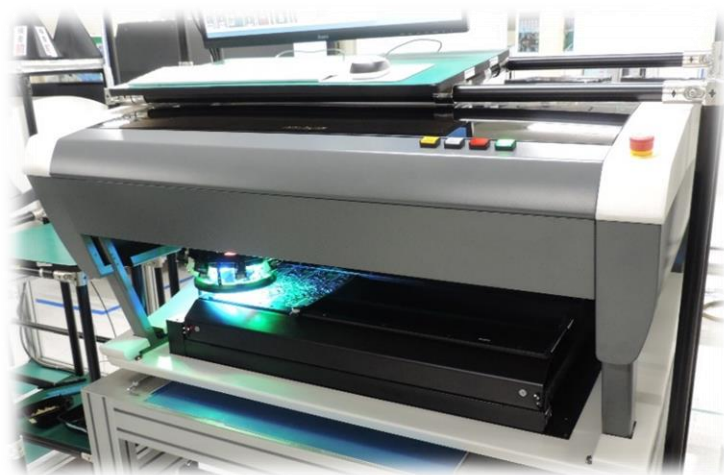
▲U22X-FMA650 (検査範囲 X:650 * Y:550) マランツエレクトロニクス製 AOI
