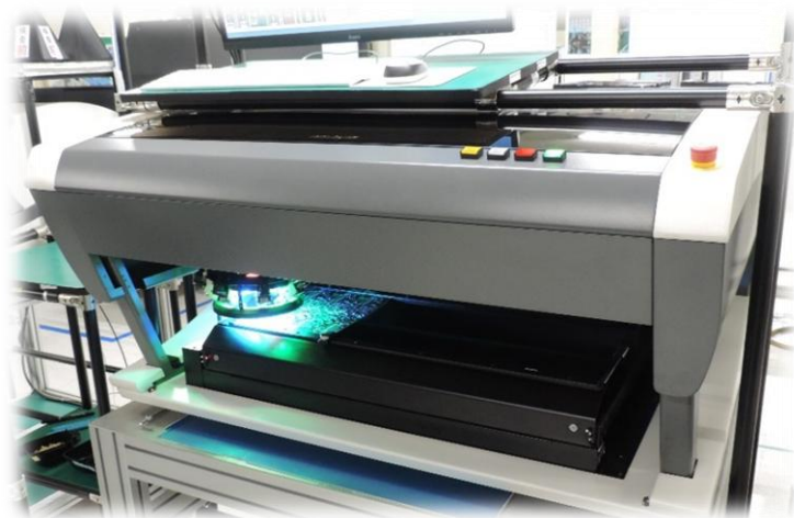
▲U22X-FMA650 (検査範囲 X:650 * Y:550) マランツエレクトロニクス製 AOI
